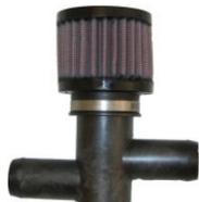
**Recommandations d'entretien :** Il est préconisé de reconditionner l'élément filtrant et le régulateur de pression toutes les 250H environ. Le remplacement de l'élément filtrant et le régulateur de pression doit être considéré toutes les 750H à 1000H.
