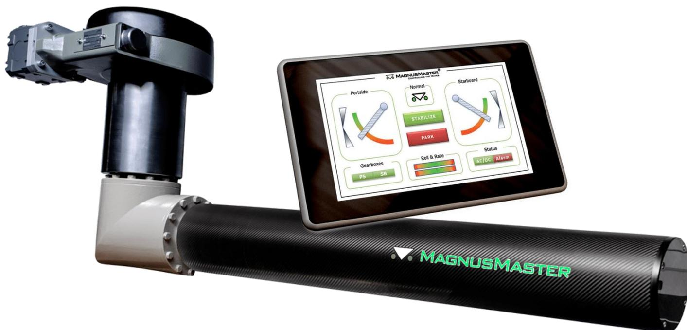
Cette dernière génération de stabilisateurs à rotor offre une réduction du roulis à faibles vitesses, de 3 à 12 nœuds, sur les yachts jusqu'à 30 mètres. À des vitesses supérieures à 12 nœuds, l'effet Magnus n'augmente plus et donc le **MAGNUS-MASTER™** se rétracte automatiquement.
